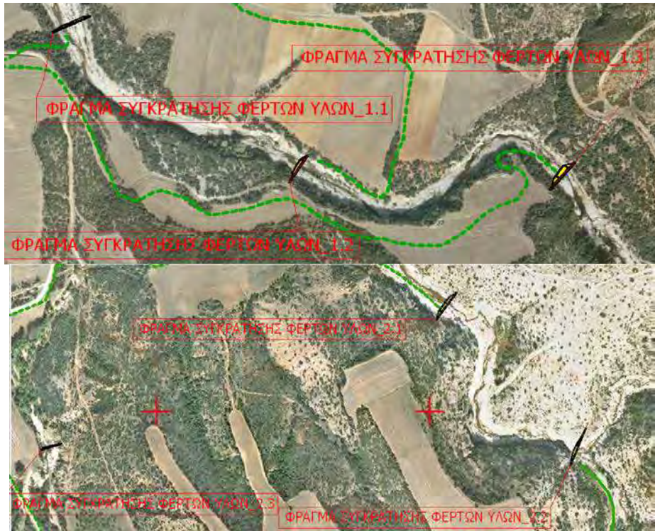
Εικόνα 5. Τα 6 φράγματα του χειμάρρου Απολλωνίας-Μελισσουργού Θεσσαλονίκης Figure 5. The 6 dams of Apollonia-Melissourgou torrent of Thessaloniki district
