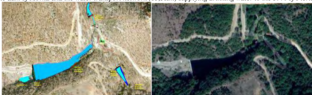
Εικόνα 2. Το φράγμα Μόρνας και το 15,5 Km δίκτυο μεταφοράς που υδρεύει το 59% του νομού Πιερίας Figure 2. The dam of Morna and the water transport network (15,5Km) supplying drinking water to the 59% of Pieria district
