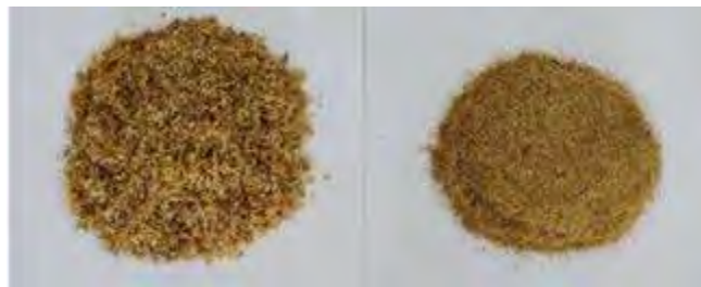
Εικόνα 1. Υπολείμματα ξύλου όπως συλλέχθηκαν (αριστερά) και το κλάσμα <1,5 mm που χρησιμοποιήθηκε μετά από κοσκίνισμα στην παραγωγή πειραματικών μοριοπλακών (δεξιά)
