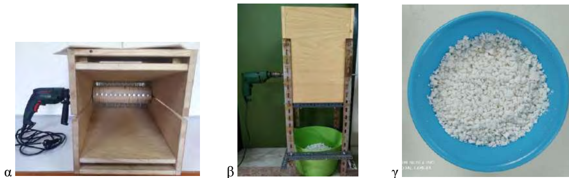
Εικόνα 2. Μηχανή θρυμματισμού ιδιοκατασκευής (α, β) και ομογενοποιημένο θρυμματισμένο υλικό PS (γ) Figure 2. DIY shredder machine (α, β) and homogeneous chipped material of PS (γ)
