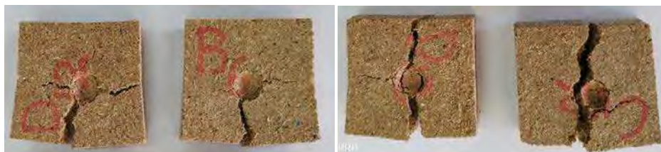
Εικόνα 5. Θραύση των δειγμάτων μοριοπλακών τύπου B κατά την διάρκεια της δοκιμής σκληρότητας Figure 5. Failure of type B partible board samples during the hardness test
